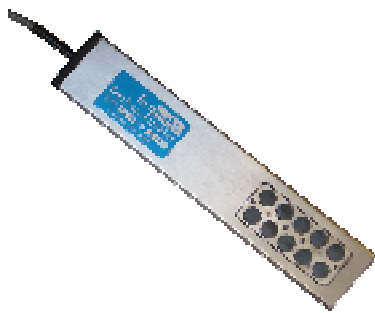
EQ15/Basic型: 用于浅层土壤安装。
