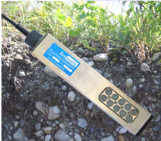
EQ15/Adapter型: 带有螺纹接头, 可连接一个管子, 将探头安装在深层土壤。
